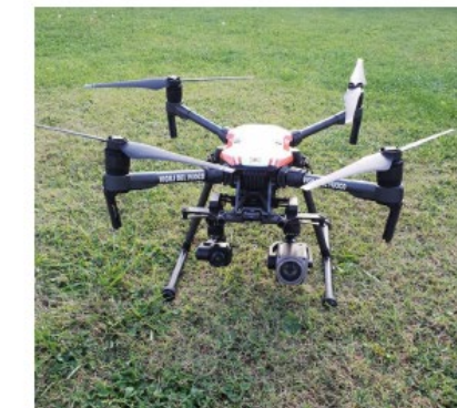
DJI Matrice 200 series MTOW: 6,15 Kg
